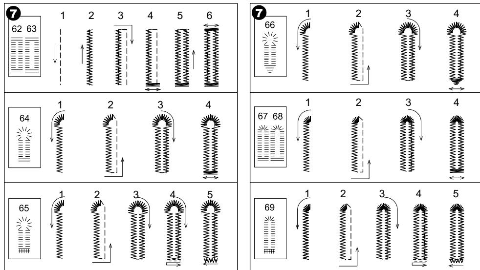
7. Die Nähmaschine näht das Knopfloch in der angezeigten Reihenfolge und hält automatisch an.
